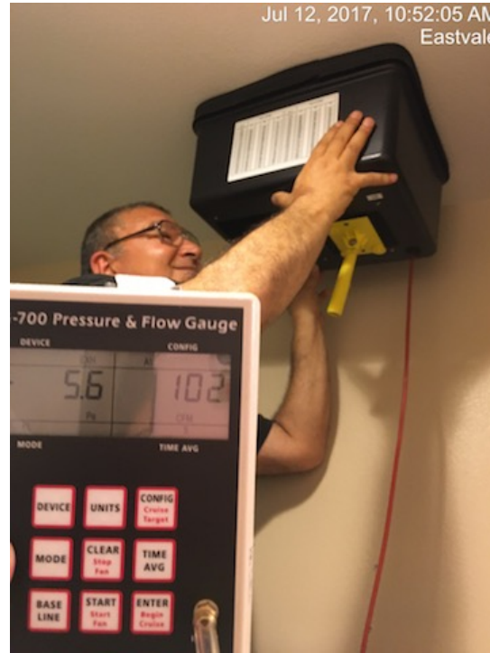
Exhaust Fan Airflow
